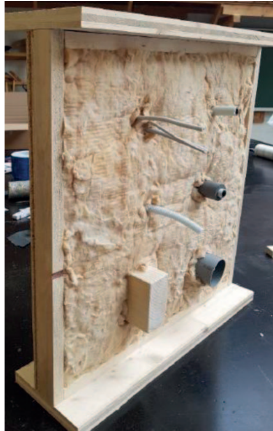
Einlegen der Wärmedämmmatte ( D = 50 \text{ mm} ) und Ausschnitt der Durchdringungen
